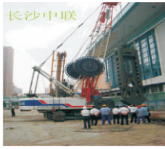
SCC2500C在美国林肯市电厂施工 SCC2500C在美国林肯市电厂，重量45.5吨，吊钩重量96000磅。
